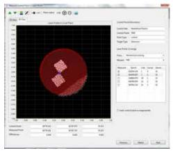
Possibilité de mesure cible automatisée des cibles en damier.
