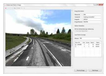
Patchs plans lidar extraits et projetés sur l'imagerie (colorée selon l'intensité) pour l'inspection visuelle du co-enregistrement entre les deux ensembles de données.
